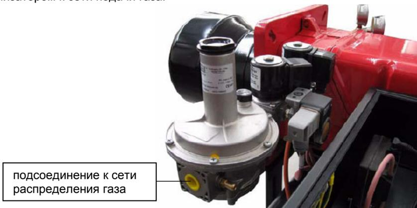
После монтажа газовой ramпы выполнить электрические подсоединения всех компонентов (клапанов, реле давления).
